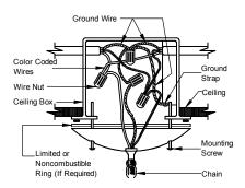
CEILING FAN/LIGHT MOUNTED ON SITE-INSTALLED DECORATIVE BEAM
